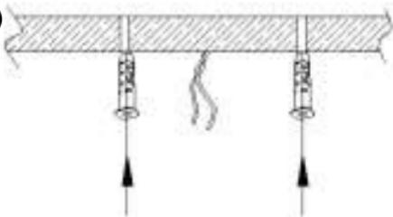
Просверлите отверстия для пробок в нужной плоскости, вставьте пробки.
